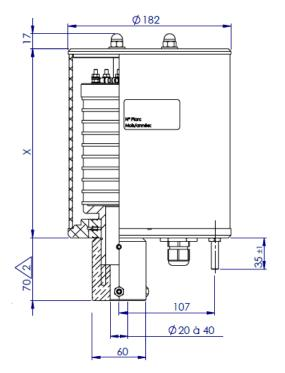
Nombre de pistes : 16 maxi Courant admissible: 25 A 400 V AC Tension nominale: 2500 V Tension d'isolement : Fréquence : 50/60 Hz Classe 1 Classe d'isolement : Indice de protection: IP54 -25/+60°C Température d'utilisation : jusqu'à 95 % Humidité relative : 100 tr/min Vitesse de rotation maxi:
