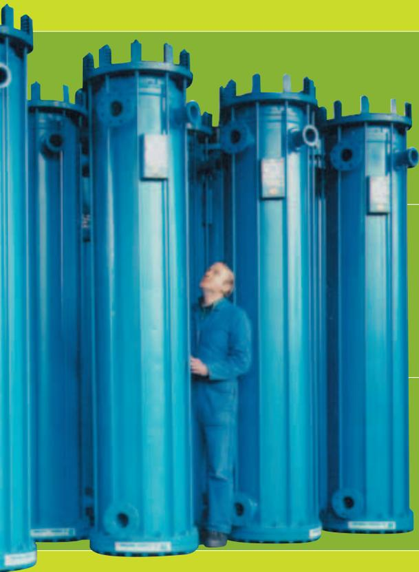
**1 -Le CL Clad®** permet de réaliser des équipements anticorrosion particulièrement performants, notamment des colonnes de distillation et des réacteurs destinés à la chimie fine et à la pharmacie.
